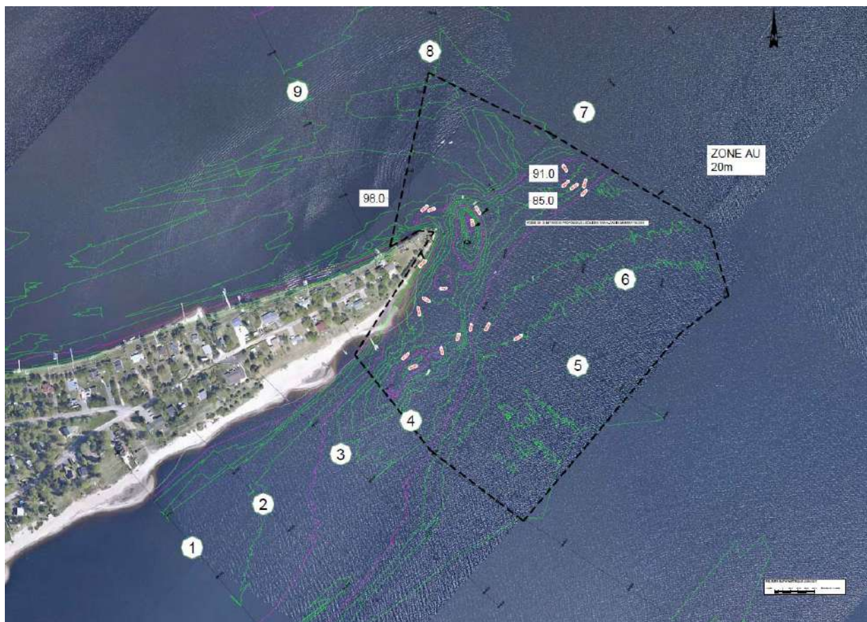
Figure 3 Position des 9 transects de relevés bathymétriques avec les courbes bathymétriques résultants de l'interprétation des relevés de juin 2017
