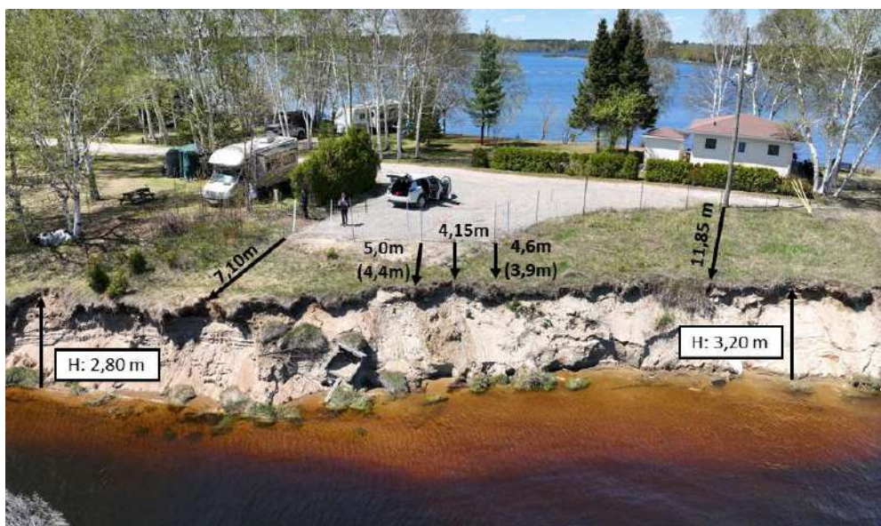
Figure 5. Distances et mesures relevées au droit du périmètre de sécurité délimitant le stationnement localisé au bout de la rue de la Pointe (MSP, le 27 mai 2025)
