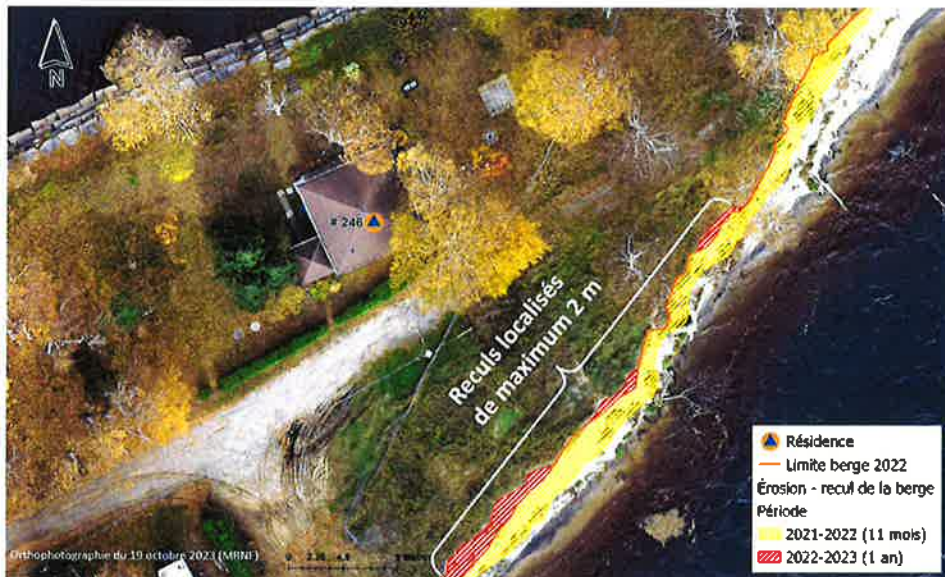
Figure 6. Évolution récente de l'érosion à proximité de la propriété sise au 246, rue de la Pointe
