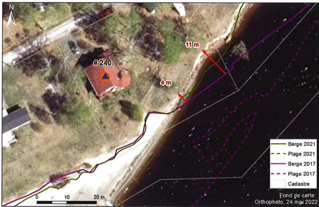
Figure 9. Évolution récente de l'érosion pour la propriété sise au 240, rue de la Pointe
