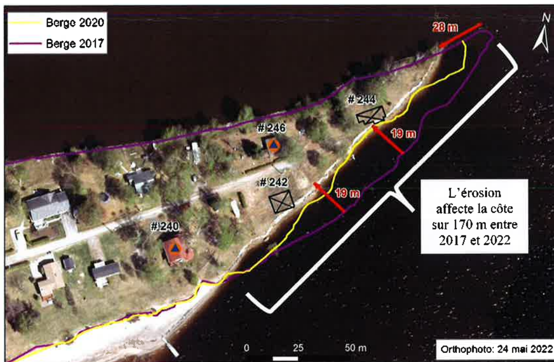
Figure 6. Évolution de l'érosion récente affectant la berge dans le secteur de la Pointe à Langevin entre 2017 et 2022
