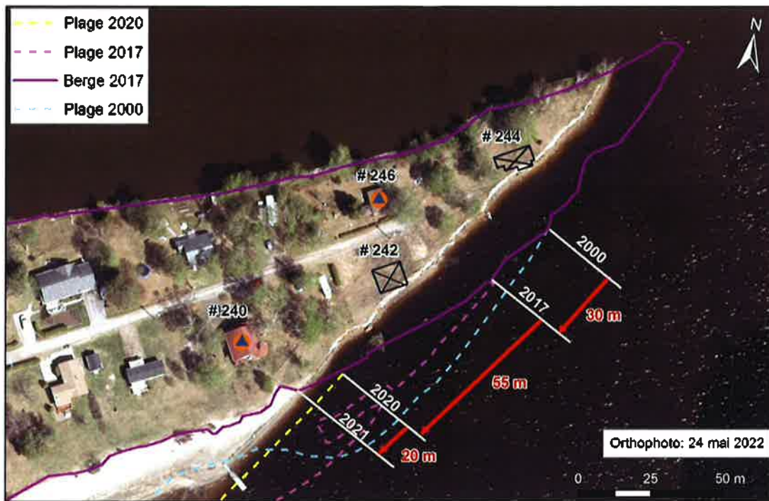
Figure 7. Recul progressif de 105 m de la position de l'extrémité de la plage sur 105 m entre 2000 et 2022
