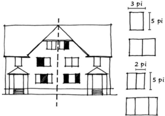
**Figure A8 - Disposition des fenêtres**
